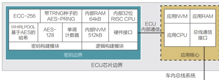
图 14 EVITA Full HSM 技术框架
