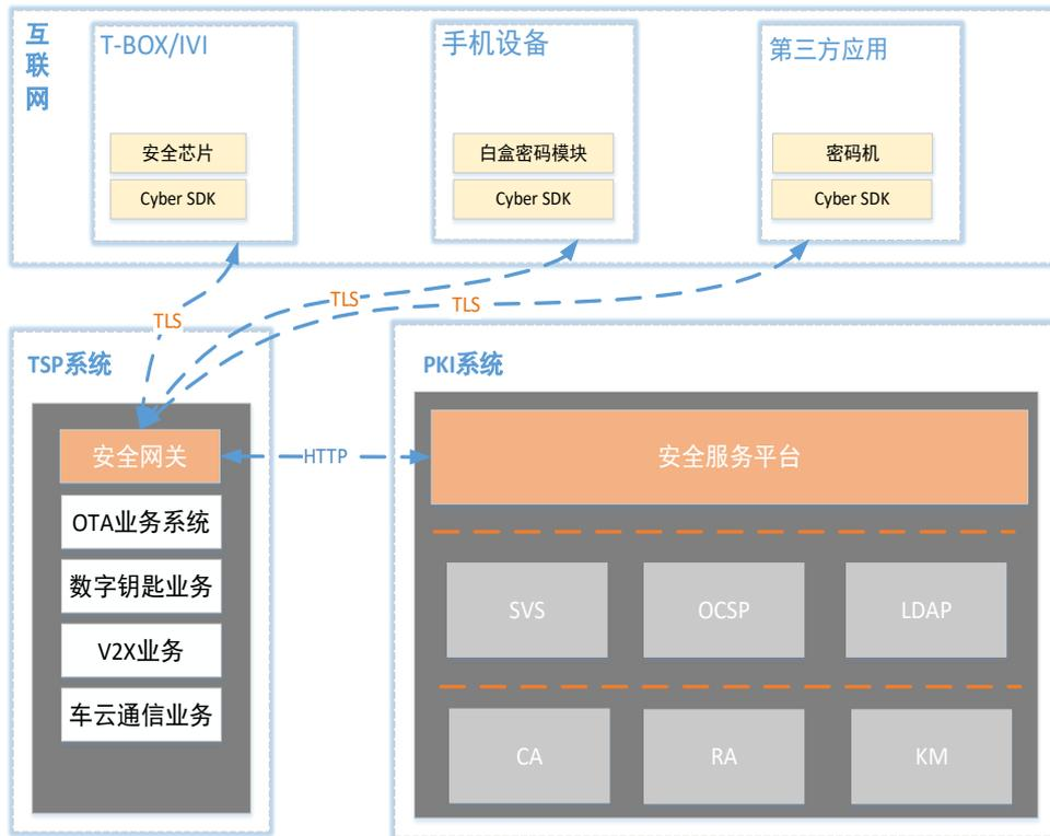
图 3 基于密码技术的车云通信安全架构
