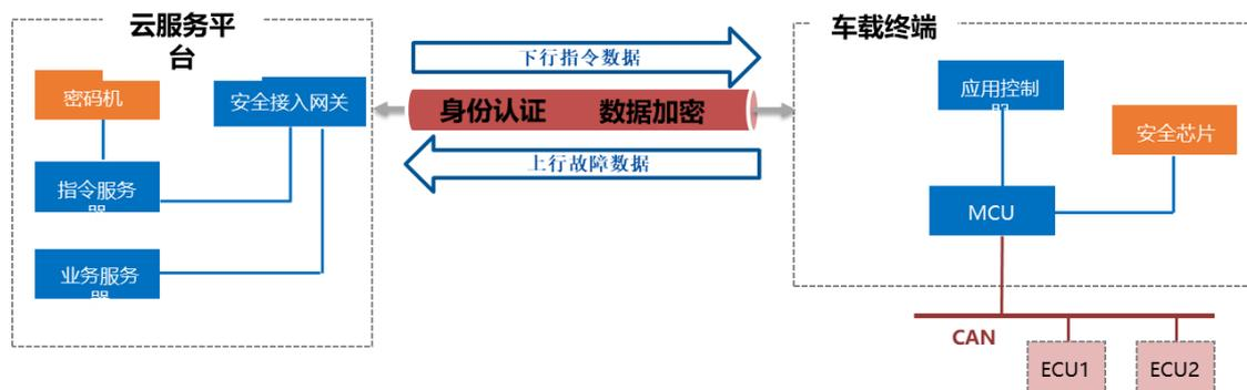
图 6 远程控制/诊断密码安全方案
