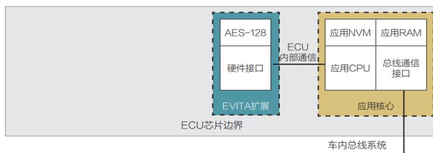
图 12 EVITA Light HSM 技术框架
