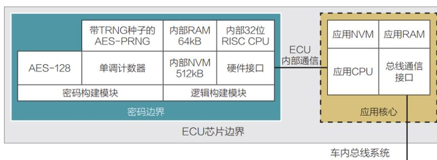
图 13 EVITA Medium HSM 技术框架
